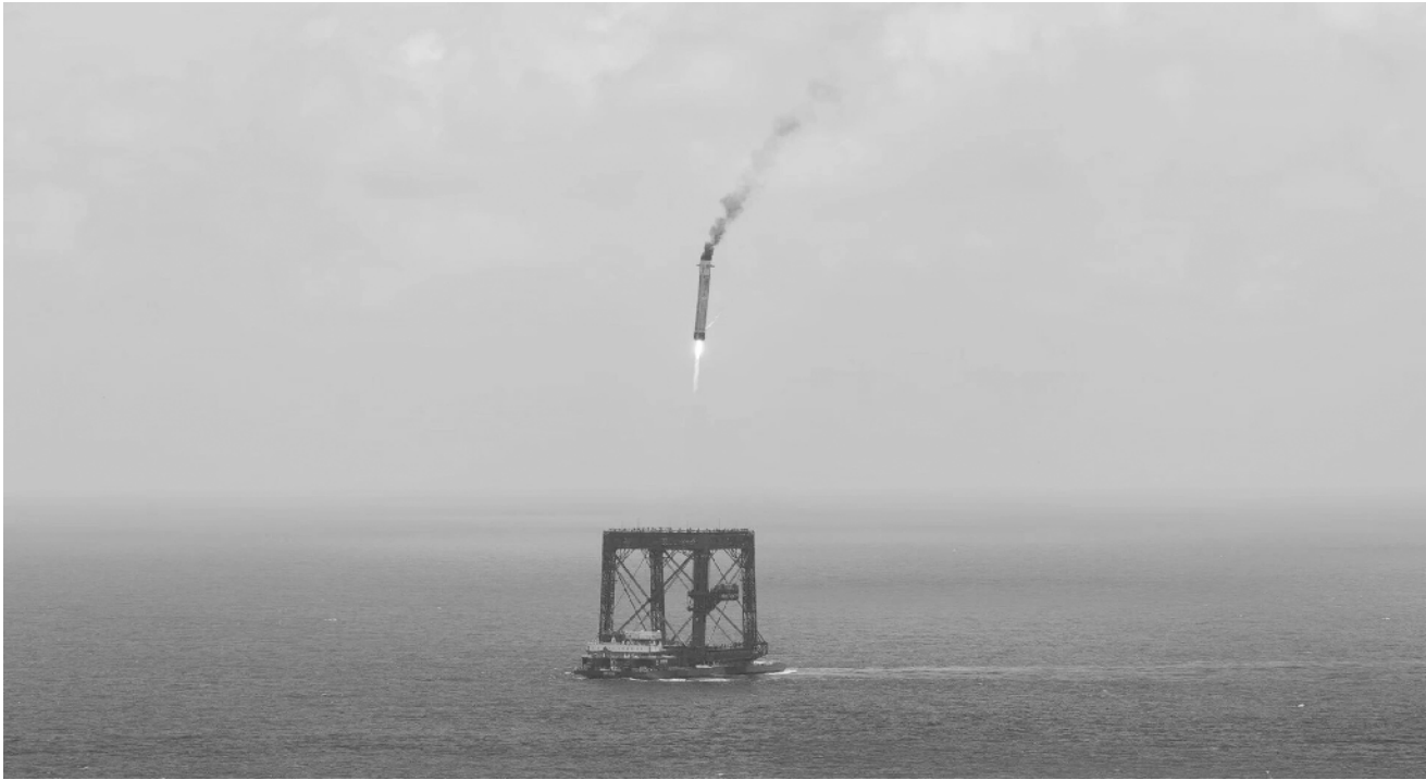
2026年7月10日,长征十号乙运载火箭在海南商业航天发射场发射升空,成功将卫星送入预定轨道,火箭一子级成功回收,任务取得圆满成功。这是海上回收平台通过网系捕获方式成功回收长征十号乙运载火箭一子级(无人机照片)。
