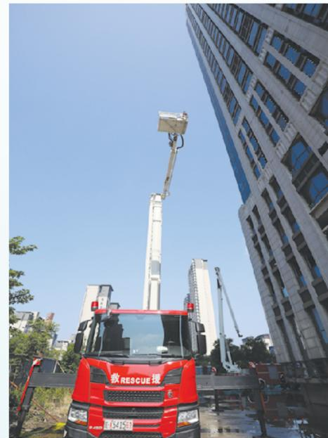
举高平台70米、喷射高度60米的消防车。
