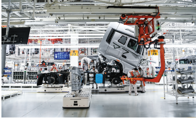
在位于吉林长春的一汽解放汽车有限公司J7智能工厂内,工人在AGV(搬运机器人)上装配车辆(2023年6月12日摄)。
