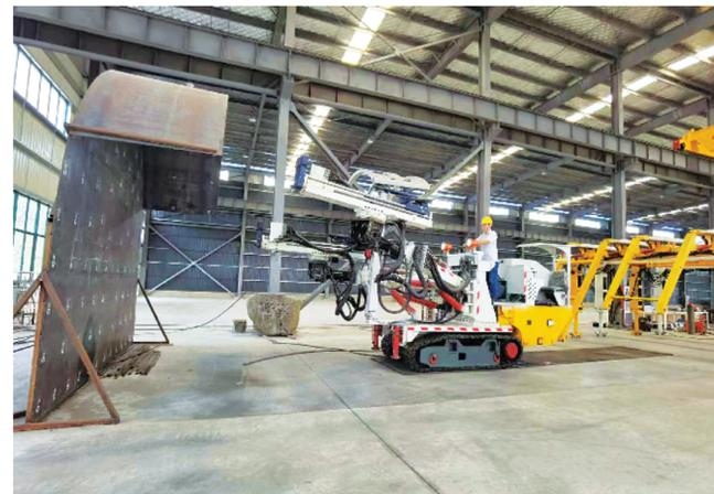
准炮眼模拟凿岩。“这款掘锚一体机凿岩机集挖掘、锚固、支护为一体，融入了最新的机械、电子高科技，备受矿山企业的
