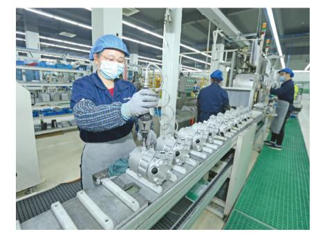
"汽车空调压缩机是汽车空调的核心部件,是汽车空调制冷系统的心脏,对产品质量的要求非常高。"梁江霞介绍说,每台压缩机都是由几百个零部件组成,涉及几十种原材料,其质量状况直接影响压缩机的性能,其中一些关键尺寸公差要求达到微米级,若尺寸偏差超过标准,就会造成压矩的技术研发实力、生产制造能力,公司还建成开发实力、生产制造能力,公司还建立了严格质量管理体系,秉持"高标准、严要求、零缺陷"的质量关,从进料检查、过程控制、成品检测等三个方面严格把关,确保把质量最好的产品交付到客户手里。
