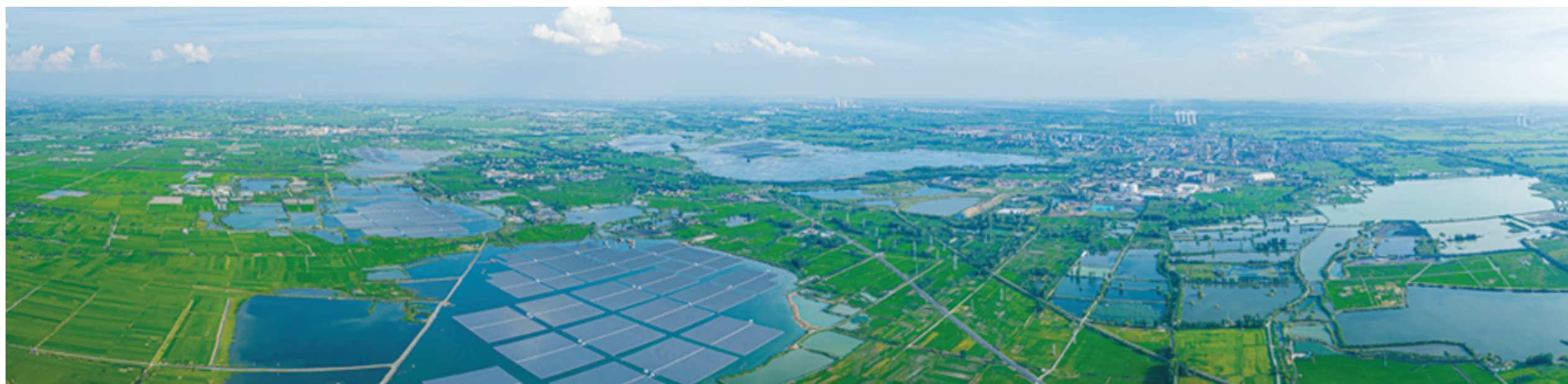
◁无人机拍摄全球最大水面漂浮光伏电站的全貌。该项目建在潘集区采煤沉陷区6000亩的水面上，总装机容量150兆瓦。
