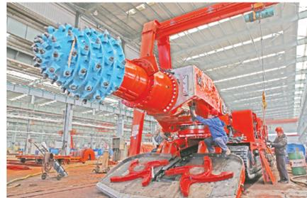
凯盛重工有限公司，工人正在装配调试大型掘进机。
